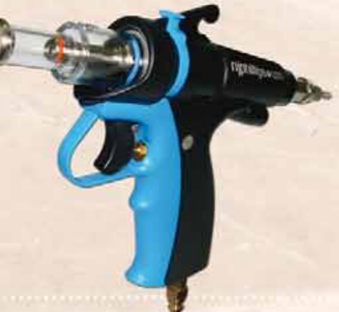
Inyector Powermaster de 15ml Código: P15G-INJ/G4 (GAS) Código: P15A-INJ/A (AIRE) Administra en incrementos de 1ml Este inyector de acción rápida está diseñado para minimizar la tensión en la mano, disponible en versiones de acople de botella de 2ml y 5ml. Propulsado por LPG y/o aire comprimido.
